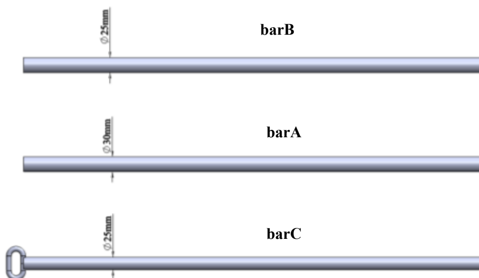
Rapido trawl. Bar diameter (Image courtesy of Emilio Notti).
